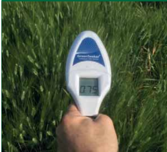
FIGURA 2 LECTURA DEL NDVI DEL CULTIVO MEDIANTE SENSOR REMOTO MANUAL GREENSEEKER® DE TRIMBLE NAVIGATION LTD., SUNNYVALE, CA, EEUU.
