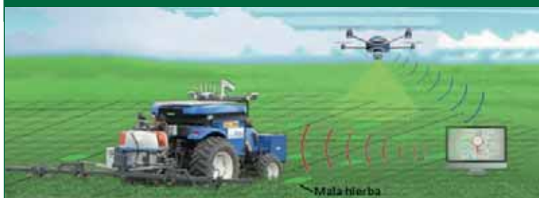
FIGURA 9 PULVERIZADOR INTELIGENTE APLICANDO ÚNICAMENTE EN LOS LUGARES DONDE EL UAV DETECTÓ MALA HIERBA EN CAMPO
