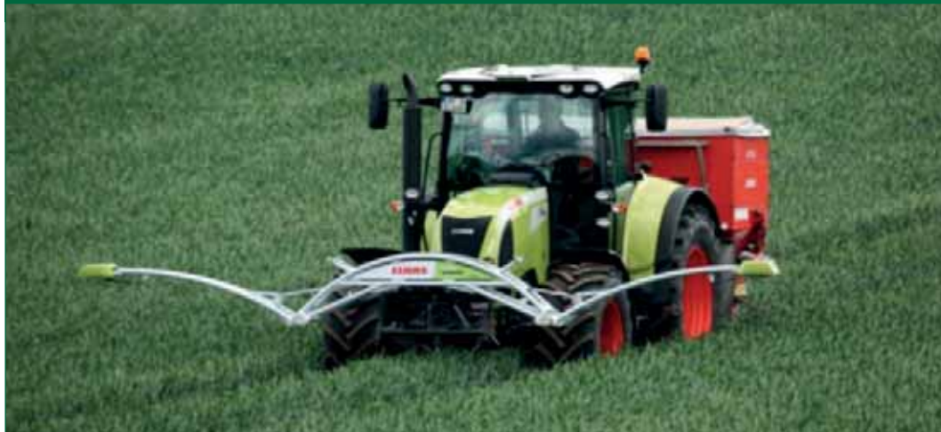
FIGURA 1 FERTILIZACIÓN NITROGENADA CONTROLADA POR SENSOR ISARIA™
