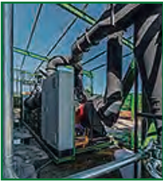
De izquierda a derecha, cuadro eléctrico y turbina de cola; y detalle del tubo de secado.
